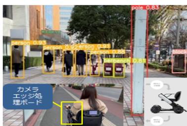
コンパクトモビリティによる障害物の検出・距離推定の自動走行実験
