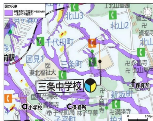
図3 豪雨時に浸水リスクが高いエリアを示す 国見地区のハザードマップ案(水本、2022)
