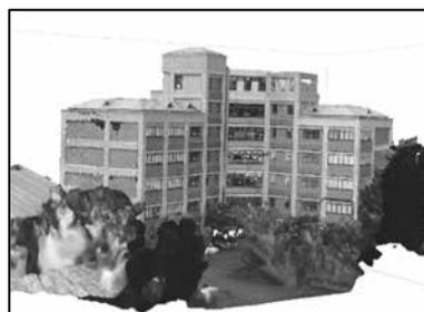
図7 ドローンで撮影された画像から構築したモデル。
