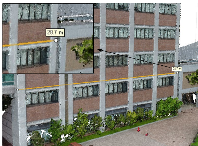
Fig. 21 3DCGモデル上の計測値
