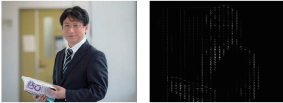
Fig. 5. 原画像（左）とHOG特徴量を用いて画像の輪郭を抽出した例
