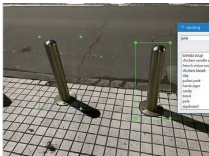
Fig.12. アノテーションツール「LabelImg」を用いてアノテーションを実行している様子（2つのポールをバウンディングボックスで囲み、カテゴリを「pole」としている）
